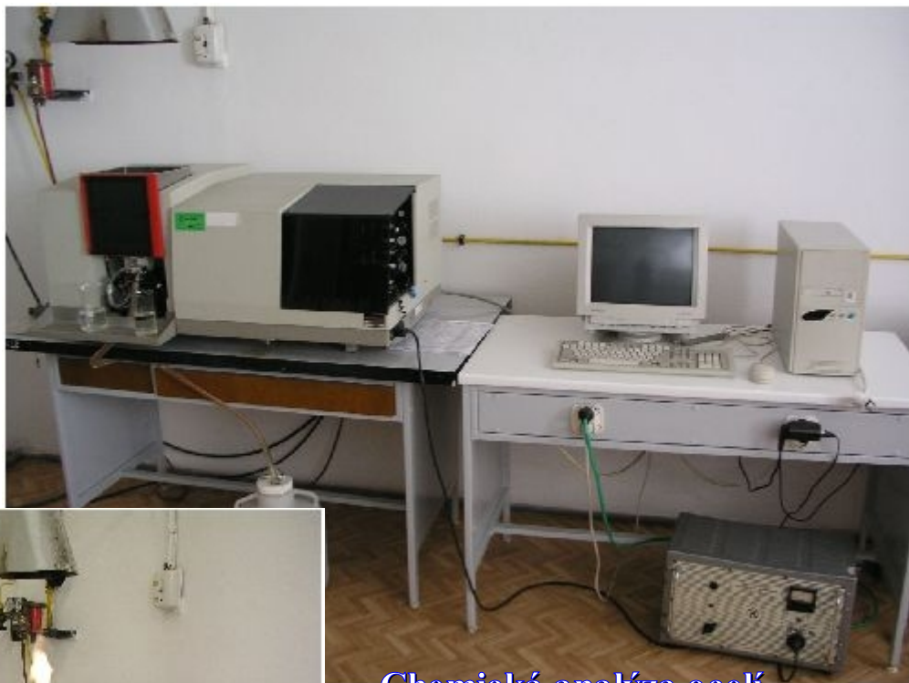
Chemická analýza ocelí na atómovom absorpčnom spektrometri fy PERKIN-ELMER, model 3300
